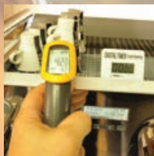
Προσοχή και στην θερμοκρασία των φηιτζανιών (45°C). Μπορεί να δημιουργήσει στην κρέμα άμεσο "κόψιμο", εικόνα καμένη αηλιά και πικρή γεύση.
